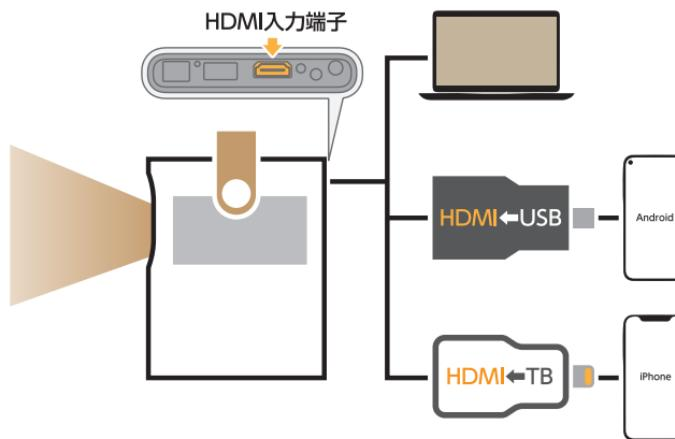
1. HDMIケーブルで本機器と再生デバイスを接続します。
