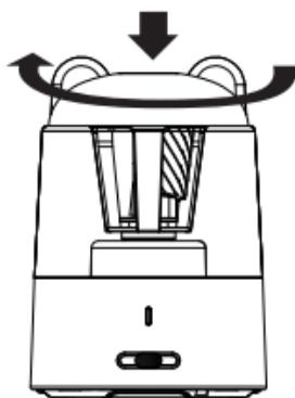
④カバーを本体に戻します。戻す際に、ケース内の歯車とブレードを噛合わせる為に一度モーターが軽く回転します。故障ではないのでご安心下さい。
