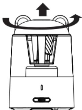
①上部のカバーを外します。耳部分を持ち反時計回りに回すとロックが外れます。
