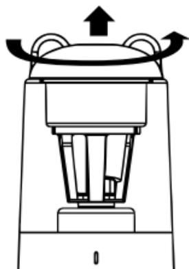
①上部のカバーを外します。耳部分を持ち反時計回りに回すとロックが外れます。
